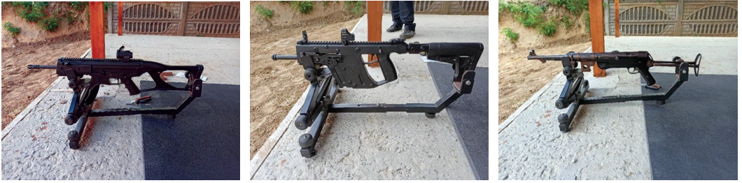
Рис. 4. Спосіб фіксації зброї калібру 9x21 мм перед проведенням експериментальної стрільби (ліворуч – «Taurus CT9», праворуч – «М.Р.38», по центру – «Kriss Vector SBR Gen II»).
