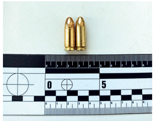
Рис. 2. Зображення пістолетного патрону калібру 9x19 mm Parabellum (ліворуч) та пістолетного патрону калібру 9 × 21 mm ІМІ (праворуч).
