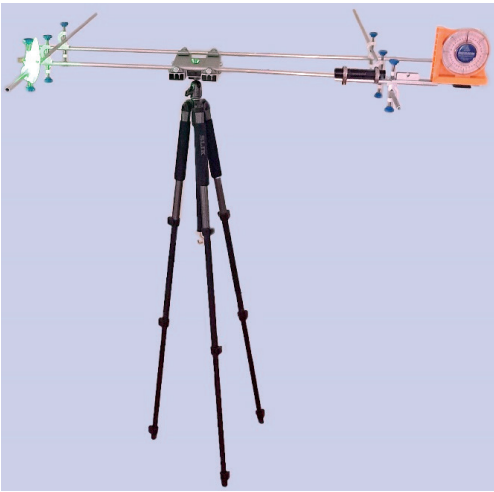
Зображення 6. Пристрій для балістичної реконструкції пострілу.
