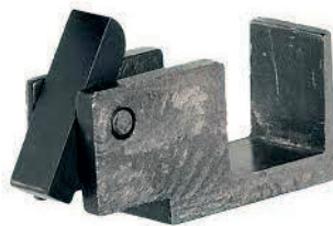
Зображення 11. Пристрої «Drop-In Auto Sear» саморобного виробництва.
